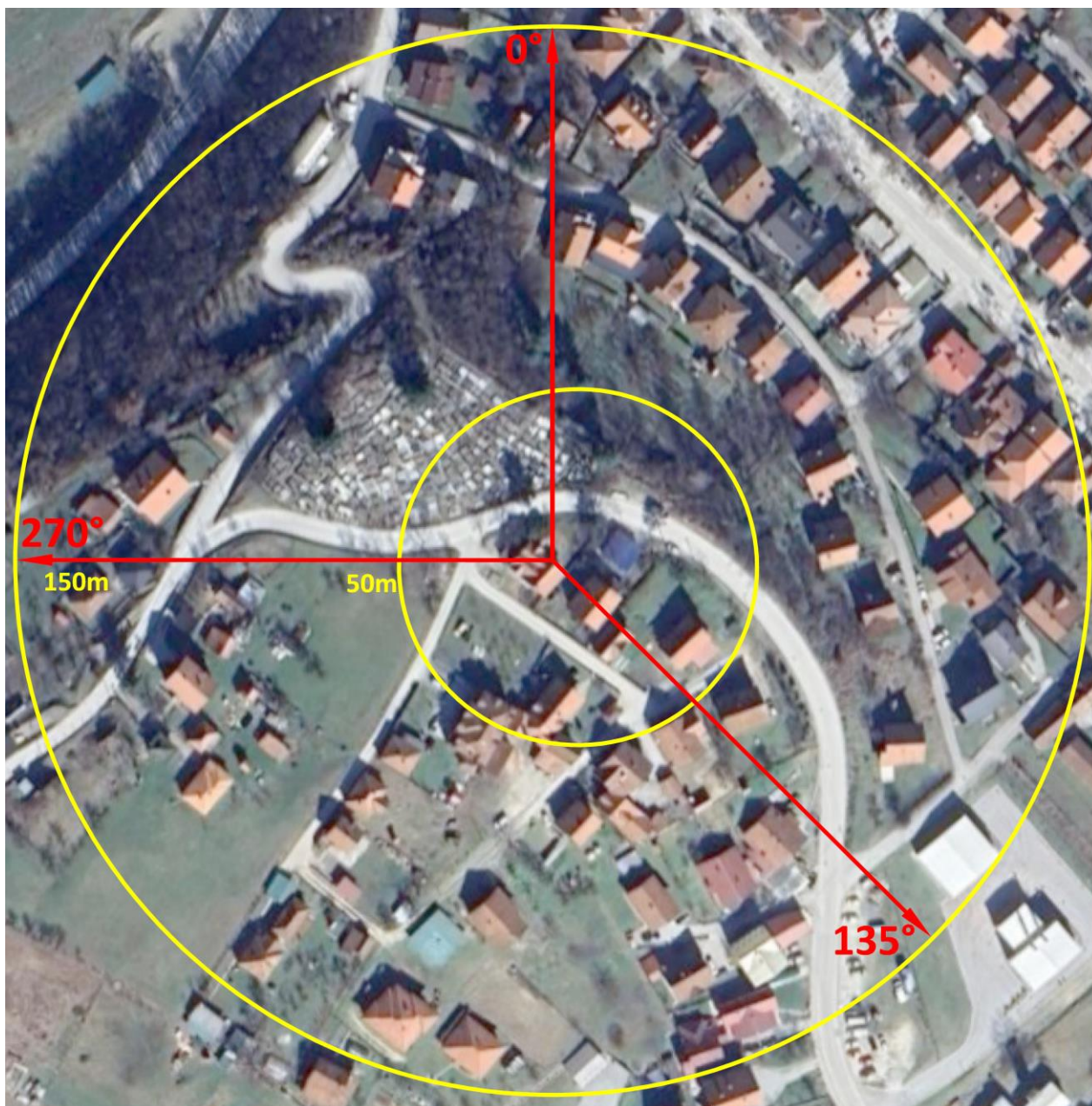
Slika 2.4 Dijagram zračenja planirane radio bazne stanice „KG3511_02 UE_Arilje_1“ 3
